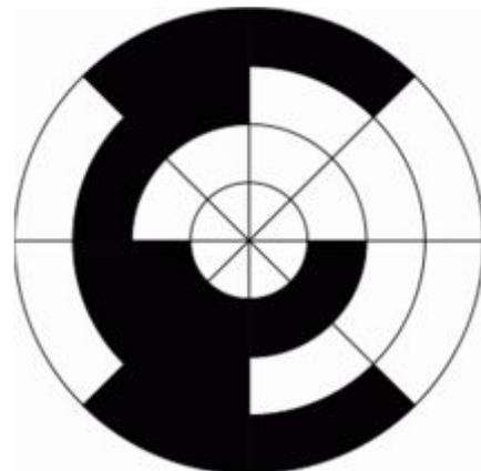
**Код Грея**, рефлексный двоичный код — двоичная система нумерования, в которой два соседних значения различаются только в одном двоичном разряде.
