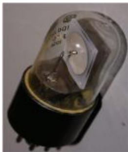
В аналоговой технике кварцы используют как полосовые фильтры. Кварцы могут работать на частотах до 50-80 мгц. На более высоких частотах используют резонаторы на поверхностных акустических волнах.
