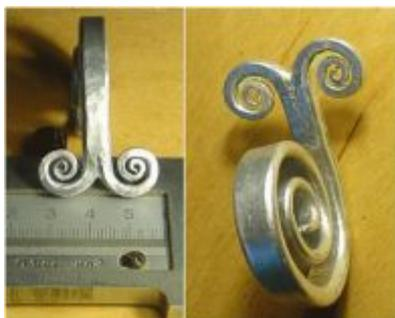
Резонатор помещен в камеру микроволновой печи с частотой 2.4ггц. Высокая напряженность поля приводит к пробое газового промежутка между концом спирали и ее частью.
