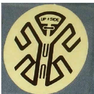
Эта картинка показывает нам RFID метку, размером 1.5 на 3 миллиметра. Рабочая частота 15 гГц. Современные приборы способны работать на частотах до 300 гГц.
